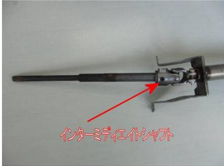
ステアリングホイールとステアリングギアボックスの間に位置するインターミディエイトシャフト、実はここにもゴムブッシュが使用されており、回転方向にゴムブッシュのタワミが発生する。
