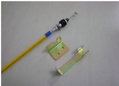
NB6Cのアクセルワイヤーは、エンジンルーム内でブラブラと揺れを生じさせないように、取り回しの途中をしっかりと固定されている。
