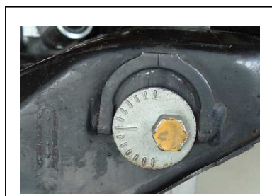
純正調整ボルト取外し
